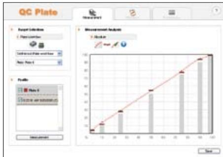
QC Plate kann Zielkurven automatisch berechnen und so die Messgenauigkeit beschleunigen. Anschließend können Sie die tatsächlichen Messwerte von PlateScope herunterladen, um eine Trendanalyse durchzuführen und Ihren Prozesssteuerungsablauf zu prüfen.
